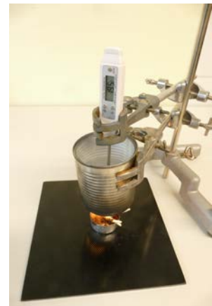
Versuchsaufbau Variante 2 mit Streichhölzern Bildquelle: Ricker, Karl-Martin (2017)
